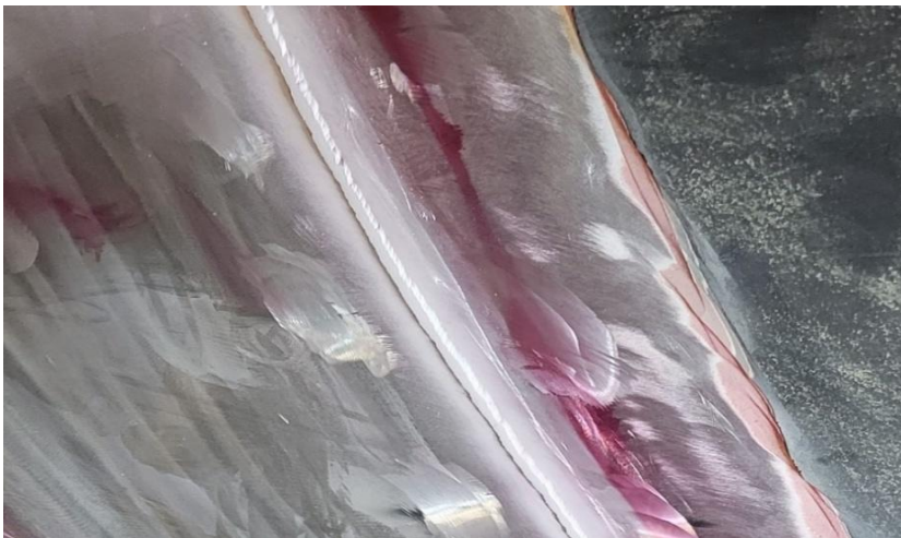
Aangeslepen sluitlaag met daarna penetrant onderzoek (PT). Als het PT acceptabel is kan aanvullend het röntgenonderzoek (RT) worden uitgevoerd.
